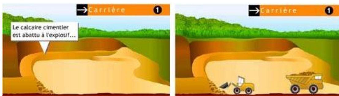
Figure I. 4 : Abattage et transport du calcaire. [4]
